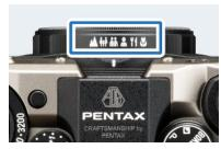
De la Macro jusqu'à l'infini, le système de mise au point du PENTAX 17 est divisé en six zones de mise au point, indiquées par des icônes représentant chaque zone. L'utilisateur n'a qu'à sélectionner l'icône la mieux adaptée à la distance du sujet sur la bague de mise au point. Dans la zone de mise au point Macro, l'utilisateur peut prendre des photos en gros plan d'une distance d'environ 25 cm. La courroie fournie permet à l'utilisateur de mesurer plus précisément la distance du sujet.
